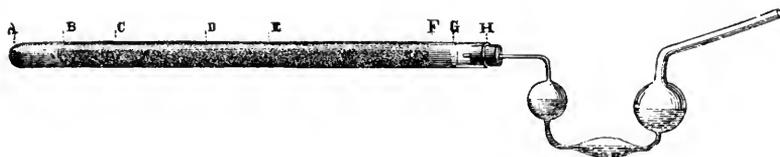
FIG. 45. — Dosage de l'azote.
